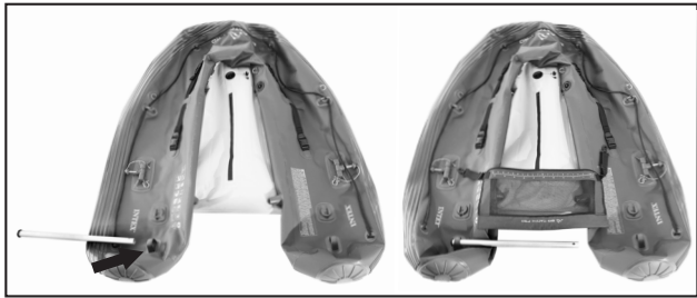
2. Raskite 2 dalių montavimo vamzdį: jį sudaro vienas ilgas ir vienas trumpas vamzdis. Įkiškite ilgą vamzdį pro vieną korpuso tvirtinimo angos pusę.
