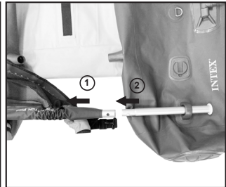
5. Įkiškite trumpąjį 2 dalių montavimo vamzdį pro kitą korpuso montavimo angos pusę ir įkiškite į ilgąjį montavimo vamzdį. Įsitikinkite, kad spyruoklinis mygtukas yra užfiksuotas.
